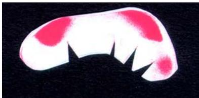
Abb. 4.43: Fuji-Druckmeßfolie mit Verteilungsmuster des Kontaktdrucks in einem linken Hüftgelenk, Typ1, Belastungsstufe 75%KG.
