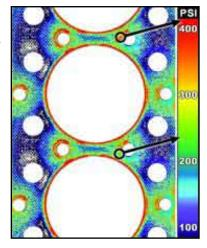
la magnitudine di pressione. Pressurex è in grado di rivelare superfici di pressione da 2 a 43,200 PSI (0.14 a 3,000 kg/cm² ).
