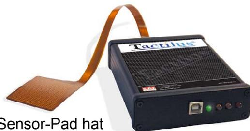
Sensor-Pad hat 625 resistive Sensorpunkte, die in einer 25 x 25 Matrixangeordnet sind. Die gesamte Drucksensorfläche ist 2" x 2". Die Messgeschwindigkeit ist bis zu 100 Hz und der Druckbereich im Messbetrieb wird mit 0 bis 7 kg/cm<sup>2</sup> (0 bis 100 psi) angegeben, als Messfehler sind weniger als ±10% zu erwarten.
