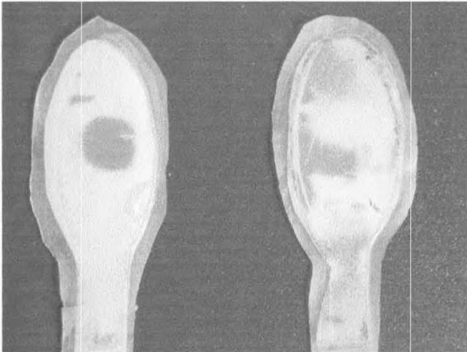
Abbildung 4: Druckverteilung ohne (links) und mit (rechts) Meniskus.
