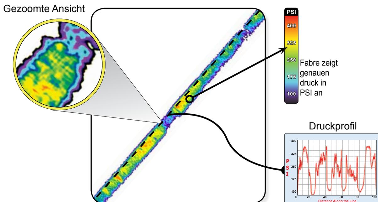
Die Pressurex® Folie zeigt das Druckprofil des Walzenspalts in der Laminierpresse an
