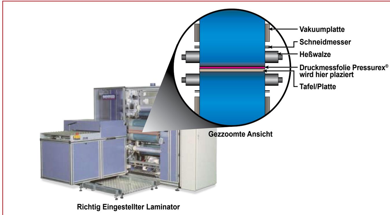
Mit Hilfe der Folie kann der Laminator richtig eingestellt werden
